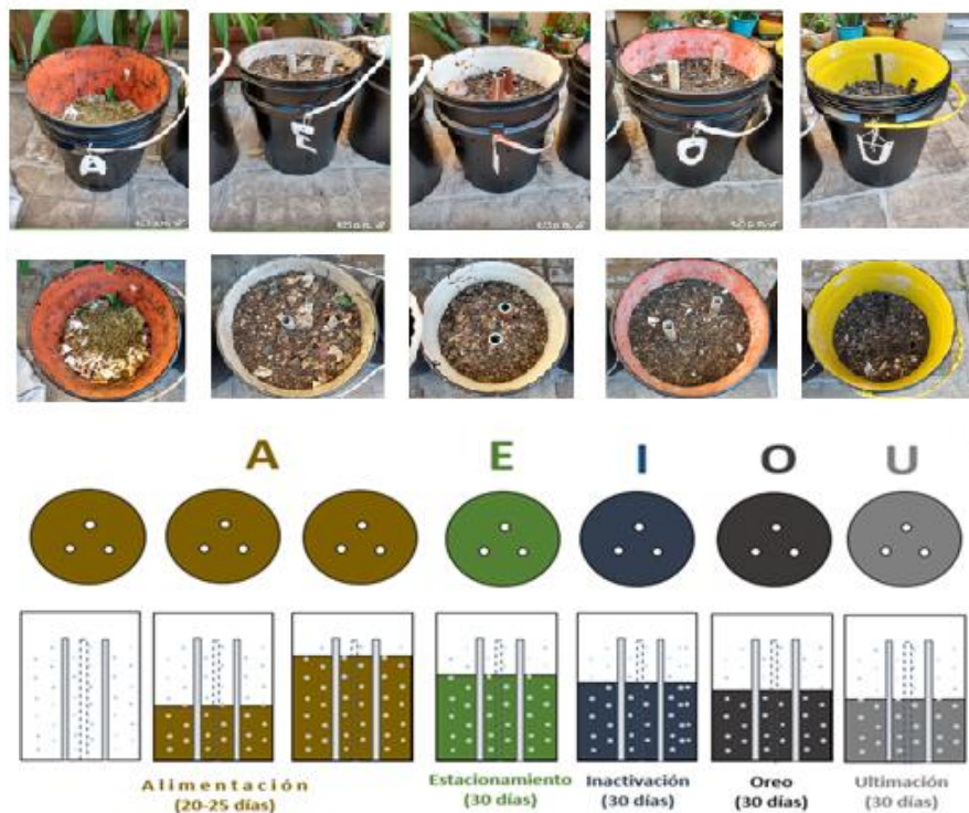
Figura 1. Superior: Fotografía de los biorreactores. Inferior: Esquema del sistema. La indicación de niveles pretende mostrar el cambio en el volumen.
